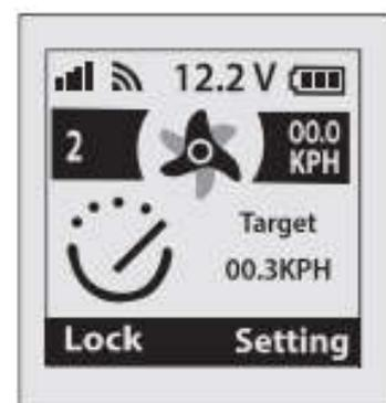
Примечание - Режим не может быть запущен, когда гребной винт не вращается. Функция круиз контроль может выполняться одновременно с режимом навигации или режимом Курс/Направление.
