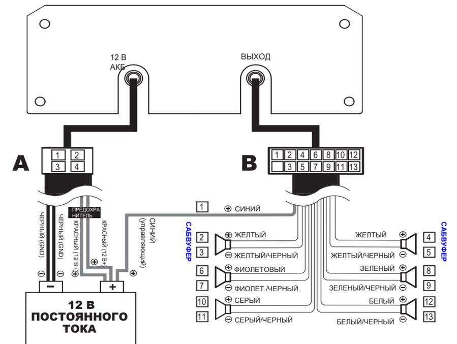
A - Подключите два черных провода к минусовому источнику питания 12 В, подключите два красных провода и один синий провод к плюсовому источнику питания 12 В.
